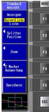
Eine Messung kann durch Auswahl der Taste "F5" in der Standardansicht automatisch im internen Speicher des Gerätes abgelegt werden.
