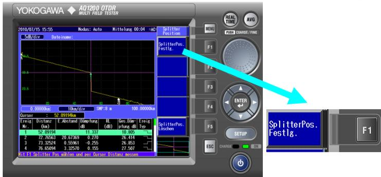
Durch Vor Druck auf F2 sollte das Ereignis per Pfeiltaste ausgewählt werden, bei welchem es sich um einen Splitter handelt. Per F2 wird man in das Splitter Referenz Menü geführt und kann direkt oder nach CURSOR Nachpositionierung mit F1 die Splitterposition festlegen.
