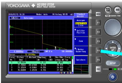
Durch Auswahl von F4 kann die Distanz- und die Dämpfung zwischen 2 Markern bestimmt werden.
