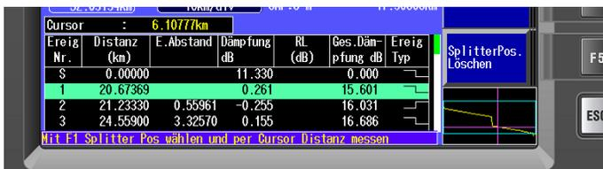
Die Empfehlung in der untersten Zeile weist jetzt darauf hin, dass der CURSOR nun zur Distanzermittlung per Drehrad positioniert werden kann und die Distanz direkt hinter "Cursor : " angezeigt wird als: XX.XXXXkm
