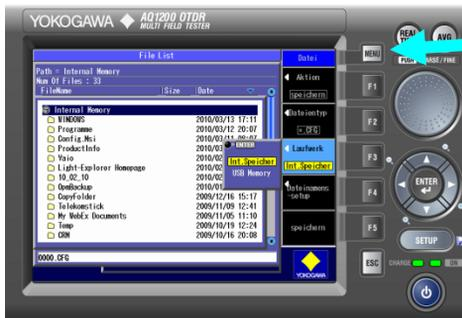
Durch Druck auf "MENU" wird das Dateimenü gestartet, in welchem Dateien ausgewählt und kopiert oder geöffnet werden können – Für den Regelfall ist dieses Menü nicht notwendig!
